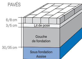
Un revêtement de sol réalisé en pavés béton se compose généralement de quatre éléments principaux :
