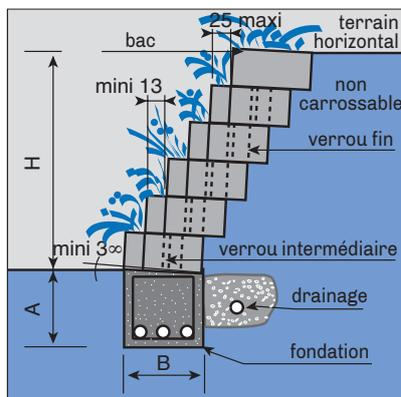
Mur de soutènement. Pose combinée avec verrous maxi 25 cm (exemple avec drainage).
